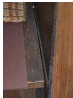
Abb.33: gelockerte Holz-nagelverbindung zw. Sitzfläche und Rückwand
